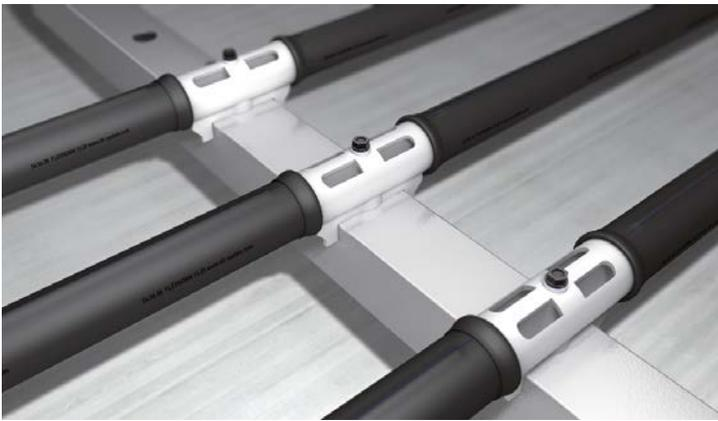
MAGNUM® 曝气器可安装在孔径为 30 或 38 mm 的圆形管道和方形分配器上。我们为适用于 DN80、DN100和DN125规格的圆管以及尺寸为 80、100、120 mm 的方管提供连接方式。
