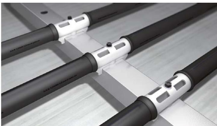
Os difusores **MAGNUM®** podem ser montados em tubagens de seção circular e quadrada, com orifício de 30 ou 38 mm. Oferecemos sistemas de ligação para tubos de seção circular, nas dimensões DN80, DN100 e DN125, assim como para tubos de seção quadrada, nas dimensões 80, 100 e 120 mm.
