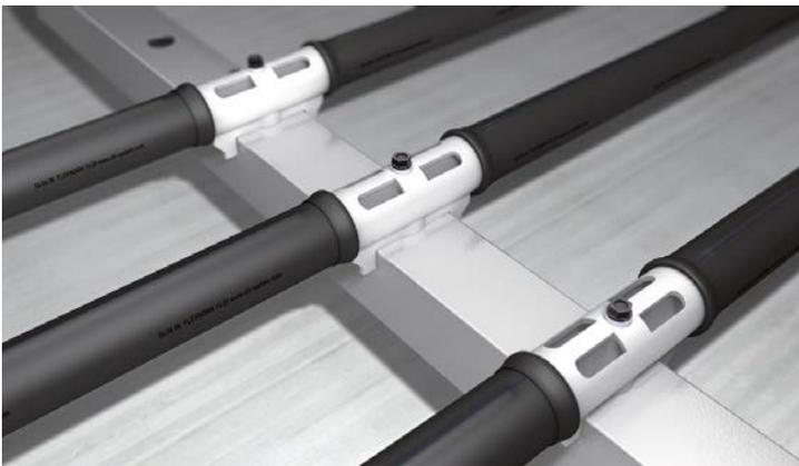
Les diffuseurs **MAGNUM®** peuvent être montés sur des collecteurs circulaires et carrés de perforation de 30 ou 38 mm. Nous proposons des variantes de raccordement pour les tubes ronds aux dimensions DN80, DN100 et DN125 ainsi que pour les tubes carrés aux dimensions 80, 100, 120mm.
