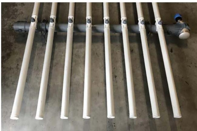
Аэрационные модули подключаются через пластиковые трубопроводы. К системе воздухораспределения аэрационные модули могут подключаться как по отдельности, так и группами. Модули фиксируются и выравниваются на дне емкости при помощи специальных крепежных петель.
