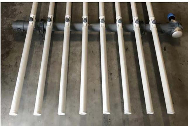
Der Anschluss der Flächenbelüfter erfolgt über Kunststoffleitungen, die am Beckenboden verlegt werden. Die Flächenbelüfter können wahlweise einzeln oder gebündelt mit dem Luftverteilungssystem verbunden werden. Über die Befestigungsglaschen werden die Flächenbelüfter am Beckenboden fixiert und nivelliert.
