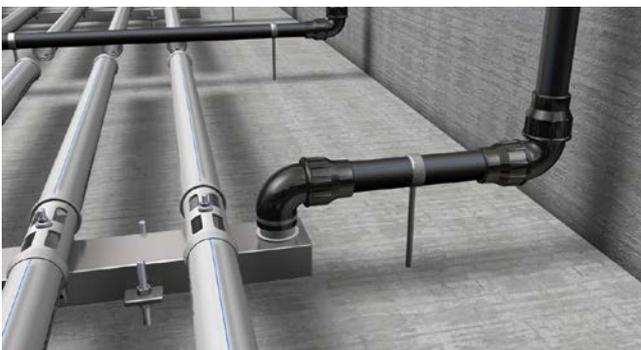
Der Anschluss der Flächenbelüfter erfolgt über Kunststoffleitungen, die am Beckenboden verlegt werden. Die Flächenbelüfter können wahlweise einzeln oder gebündelt mit dem Luftverteilungssystem verbunden werden.
